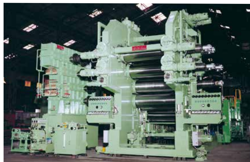
カレンダーロール機 (複合型6本カレンダー用) Calender Rolling Machines (for Plastic Film)
