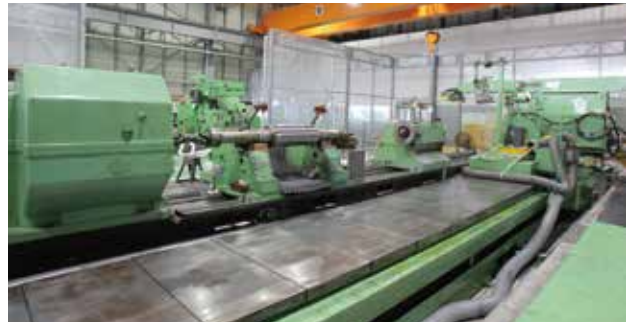
CNC大型ロールグラインダー(ワールドリッジゼン社製)
